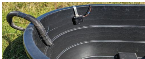
Un interrupteur marin alimente une pompe de cale qui aspire l'eau dans la baignoire.
