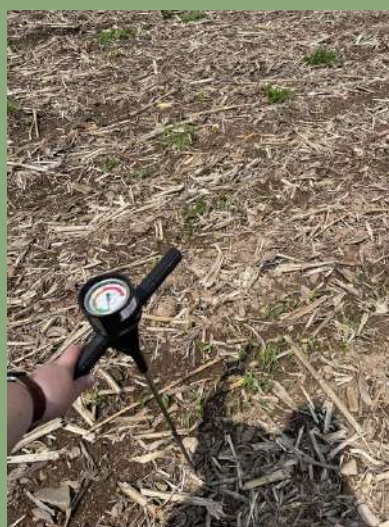
Test de compactage du sol
