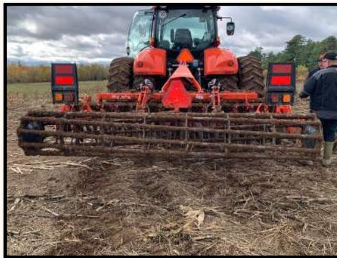
*Un disque à grande vitesse qui peut être utilisé pour incorporer le fumier.*
