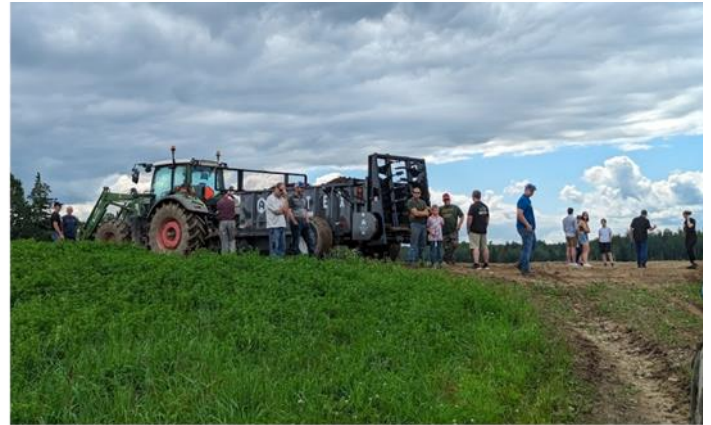
Un épandeur de fumier à batteur vertical Artex. Photo de Gabrielle Schenkels
